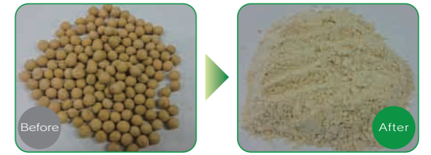
大豆100g / ステンレス容器250ml / ステンレス 20 mm × 12 個 / 液体窒素
