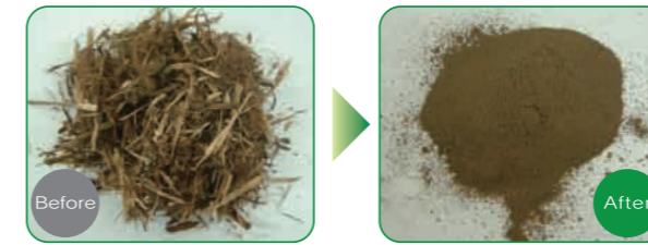
木の皮150g / ステンレス容器250ml / ステンレス 20 mm × 12 個 / 液体窒素
