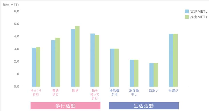
座位や通常歩行に加え、ゆっくり歩行や速歩、ジョギングなど、また、掃除、洗濯などのさまざまな生活活動も高精度に識別します。オムロン独自の信号処理※1によって、体の動きと姿勢の変化を捉え、さまざまな活動を識別することで、歩行時の活動強度だけでなく、一般の活動量計では捉えることができない生活活動時の活動強度も精度良く計測します。計測精度については、エネルギー消費量測定の基本法である「ダグラスバック法」との比較を行っています。※2
